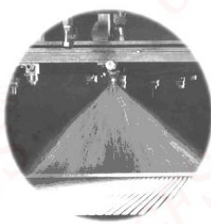
检测各水量分布点的液位值及喷嘴的喷射角度
